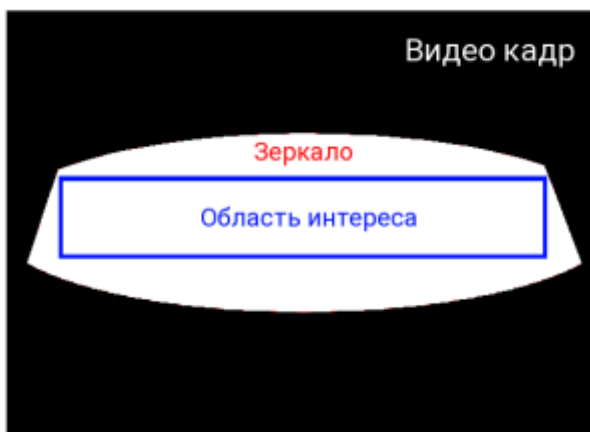
Рисунок В.4 — Схематическое изображение зеркала и области интереса
