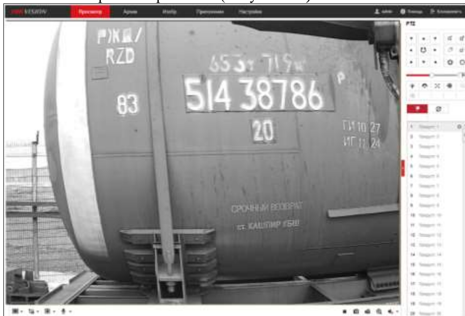
Рисунок Б.3 — Настройка фокусного расстояния и резкости
