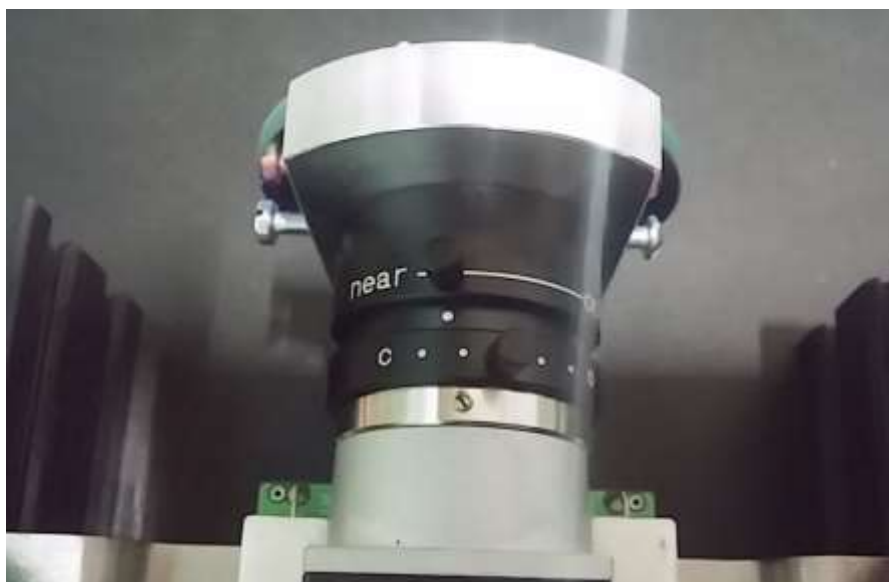
Рисунок В.6 — Рекомендуемое начальное положение (объектив Kowa LM6NCM)
