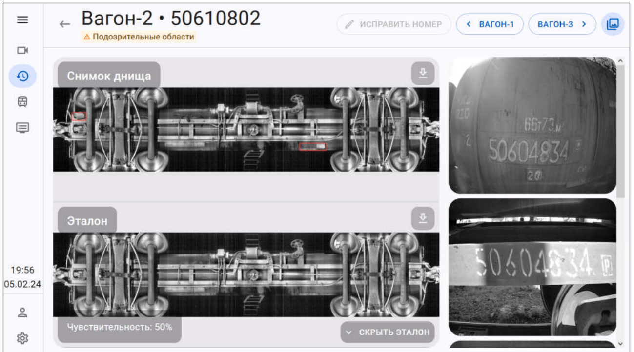
Рисунок 16 – Страница осмотра вагона (локомотива). Снимки с камер распознавания номеров
