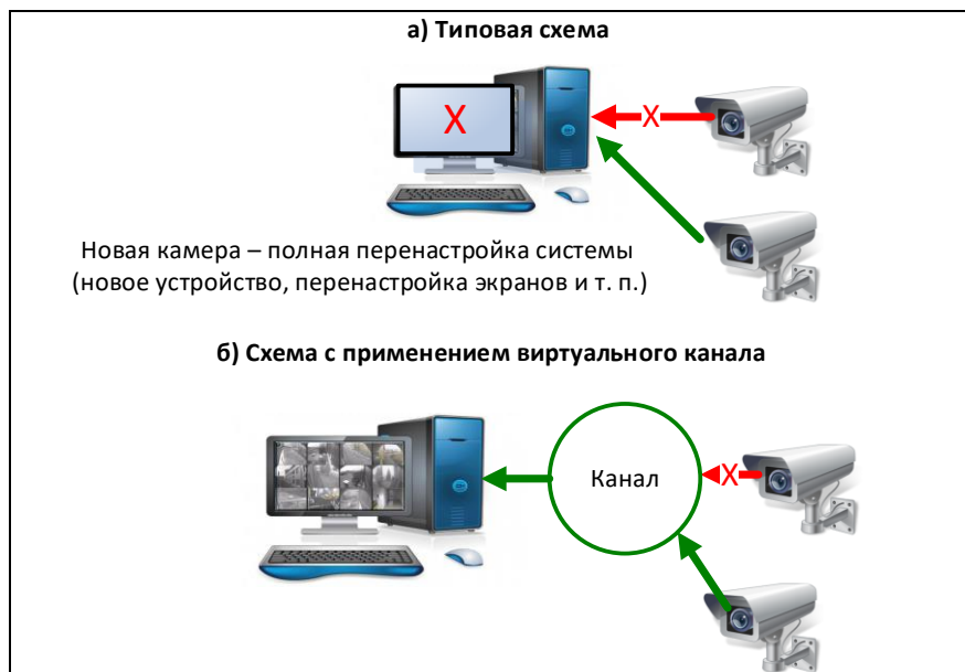
Рисунок 63 - Отличия типовой схемы организации подключения видеоустройств (а) от схемы с применением виртуальных каналов (б)
