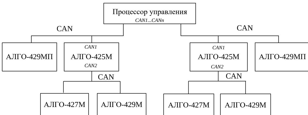
Рисунок 3 — Схема подключения контроллеров к модулям сопряжения
