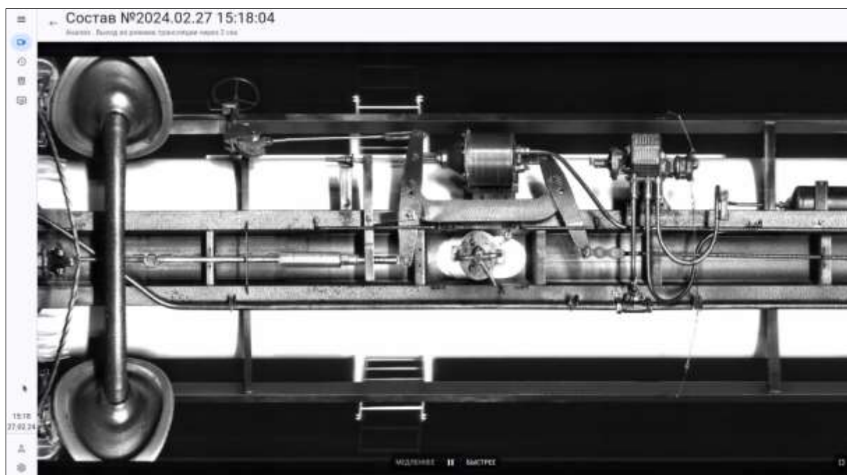
Рисунок 11 - Страница осмотра днища вагона (локомотива) с использованием трансляции с камеры ДБ в режиме полного экрана
